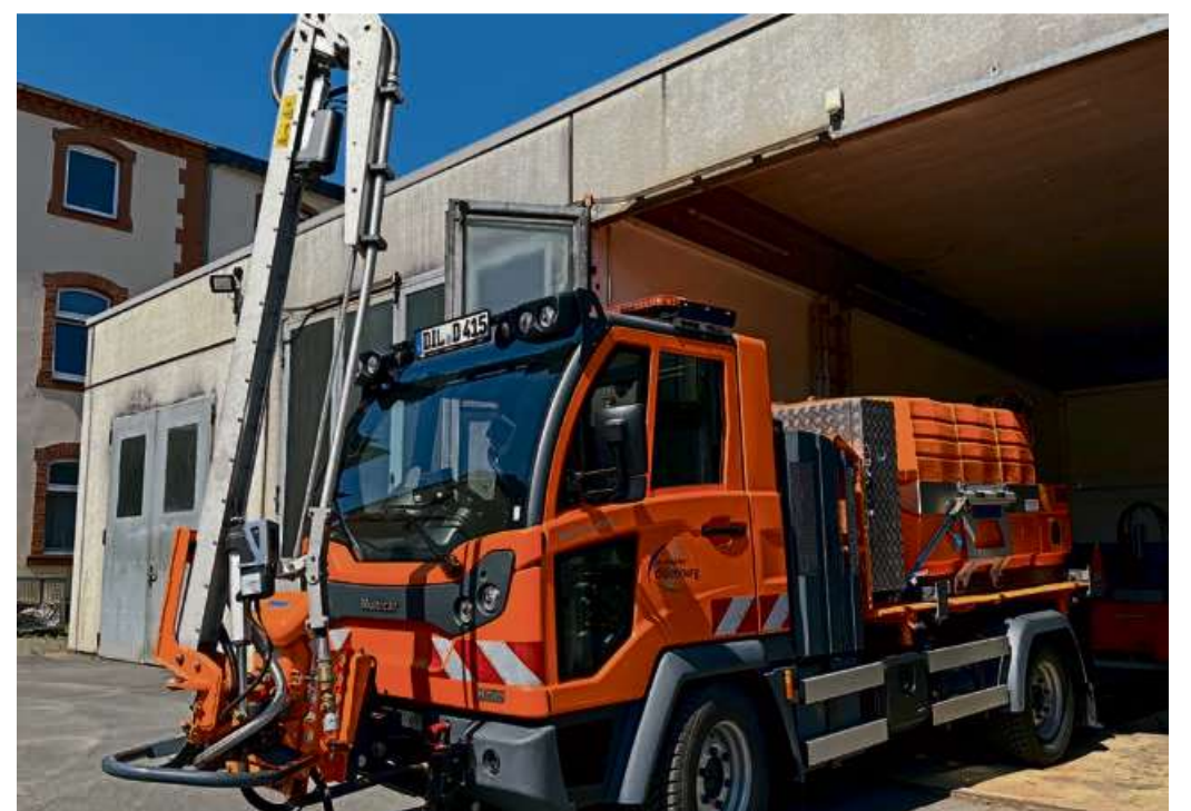
Der Multicar ist mit einem Gießsystem und einem dazugehörigen Gießarm ausgestattet, der aus dem Fahrzeug heraus gesteuert werden kann. Foto: Stadtwerke Dillenburg
